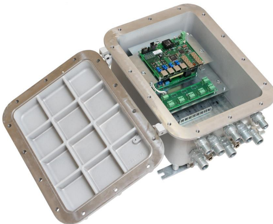
Рисунок 2.1.2 - PSW-2G+Ex – вид внутри
